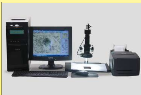
Medición con microscopio electrónico del diámetro de la marca (laboratorio Ultimheat)
